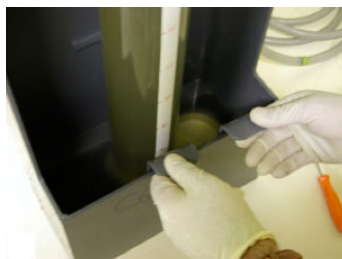
Figure 57 : Mise en place de la nouvelle coupelle
