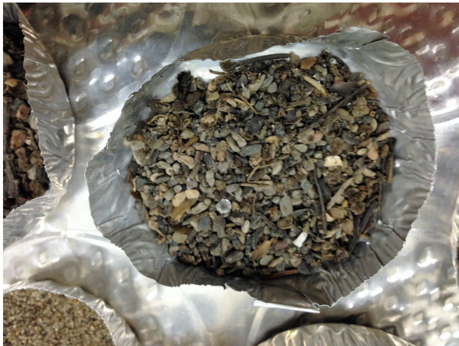
Figure 48 : Particules retenues sur tamis de 1,40 mm
