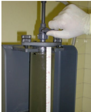
Figure 56 : Fermeture de la vanne \frac{1}{4} de tour
