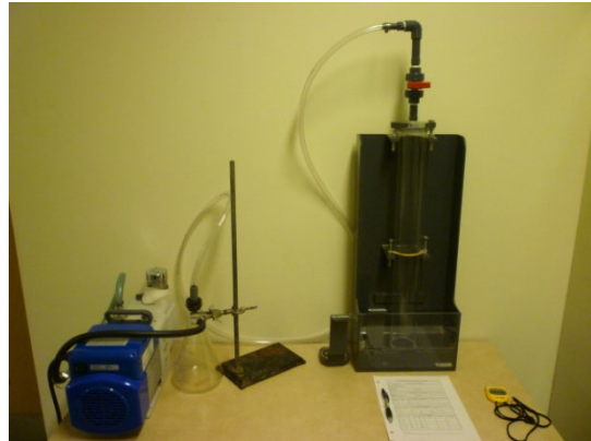
Figure 53 : Matériel ViCAs avec système de remplissage
