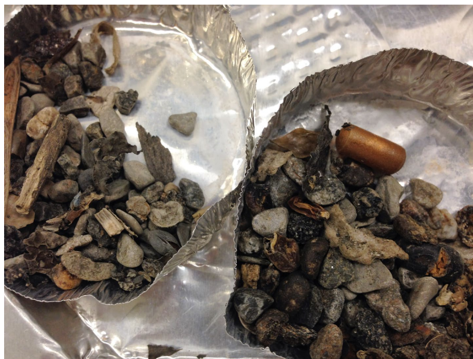
Figure 46 : Particules retenues sur tamis de 3,35 mm (à gauche) et sur tamis de 4,75 mm (à droite)
