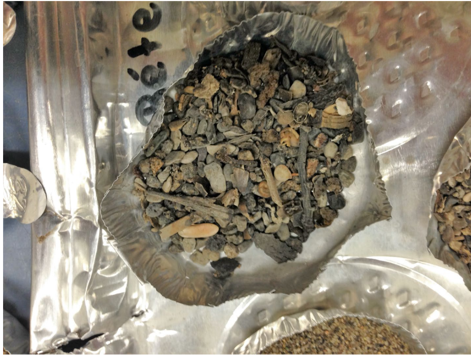
Figure 47 : Particules retenues sur tamis de 2,36 mm
