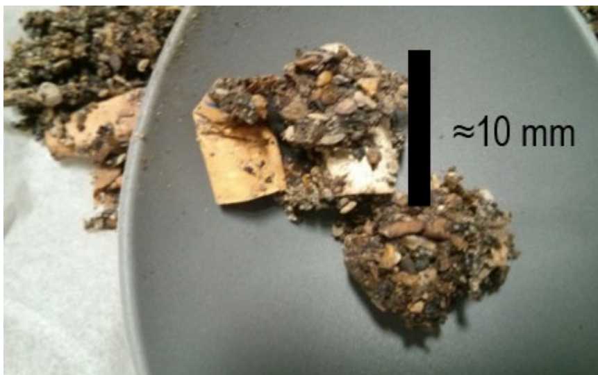
Figure 22 : Agglomération des particules de « grit » suite au séchage à 105°C
